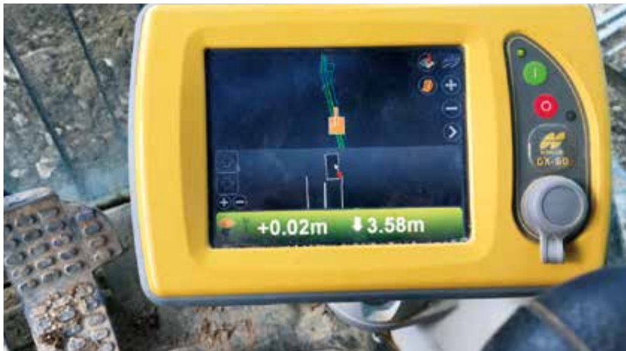
3-D-Baggersteuerung mit Stufengraben für Kanalbau
